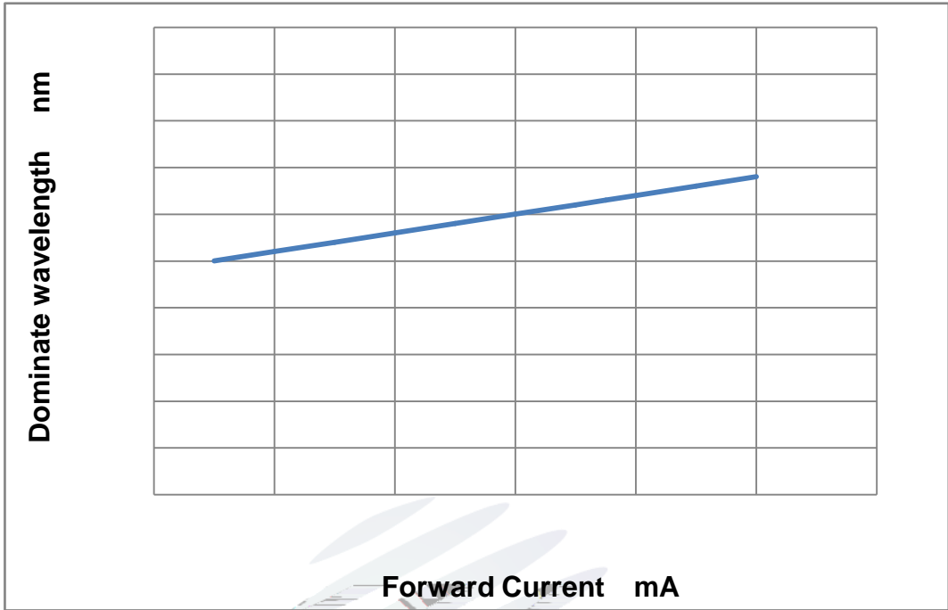
Fig. 1-13 Forward current vs. Dominate wavelength 正向电流与主波长特性曲线 (Ts=25°C)
